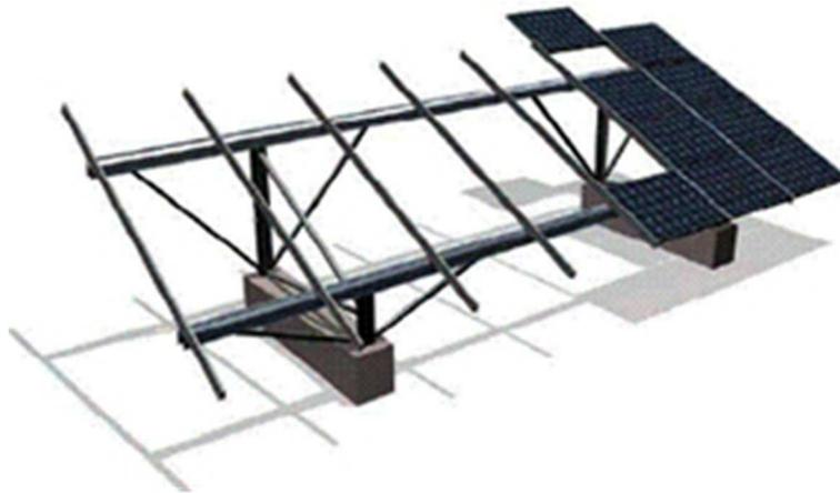
Vue 3D schématique de la structure porteuse - (Source : ENGIE Green)
